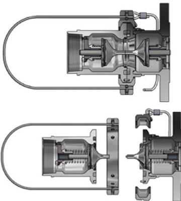
Nottrennkupplungen werden verwendet, um Wegfahrunfälle zu verhindern, Terminals sowie Be- und Entladegeräte zu schützen und unerwünschte Produktfreisetzungen zu vermeiden. Die Nottrennkupplungen besitzen eine vordefinierte Bruchstelle, die bei einer festgelegten Bruchlast bricht. Dabei schliessen die integrierten Ventile automatisch den Durchfluss auf beiden Seiten.
